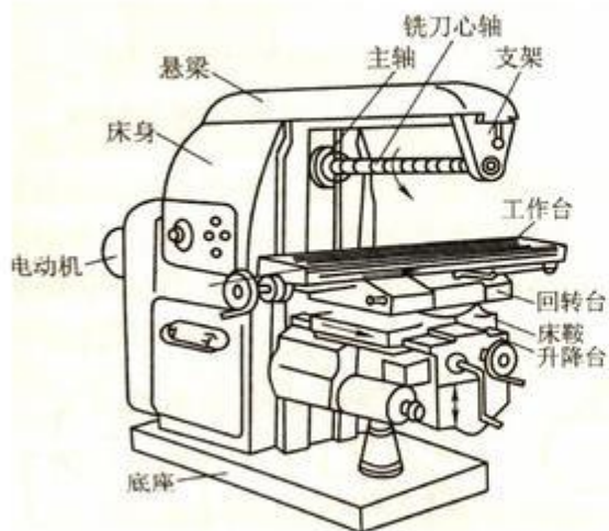
X6132 型万能升降台卧式铣床外观图
