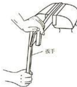
图 11-61 板条料扭曲的矫正
